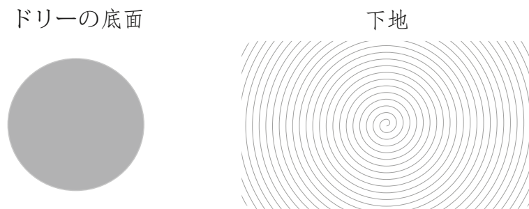
c) 接着剤層剥離
